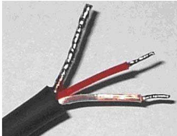
Du côté de la fiche femelle, le but va être de rassembler les deux câbles et donc leurs conducteurs. Les conducteurs seront torsadés ensemble et ensuite soudés.
