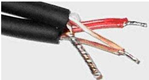
*Il ne nous reste plus qu'à souder notre câble sur la fiche XLR femelle d'un côté et sur les deux fiches XLR mâles de l'autre côté.*
